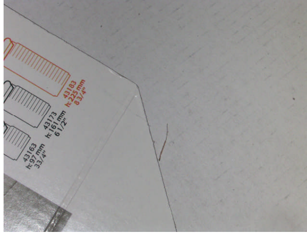
Şekil 3.2: Sakal kesim hatası
