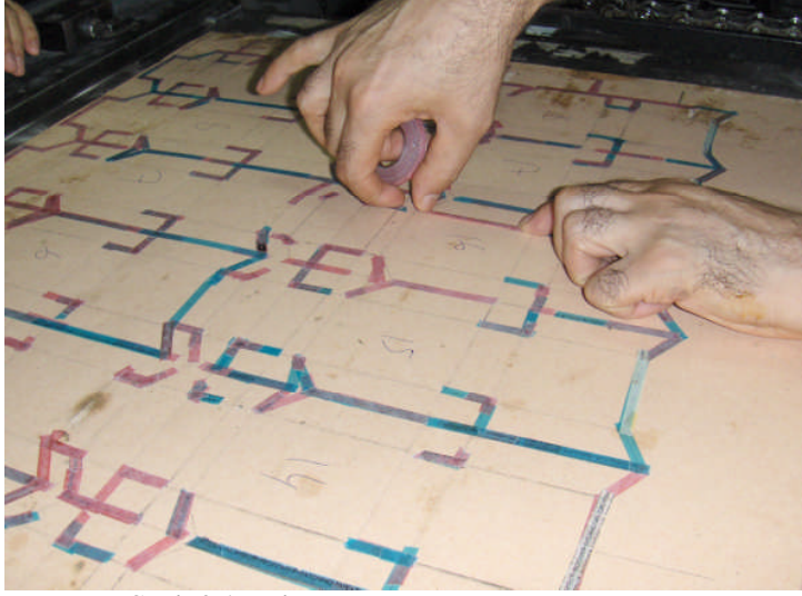
Şekil 2.1: Mizantren bandının yapıştırılması
