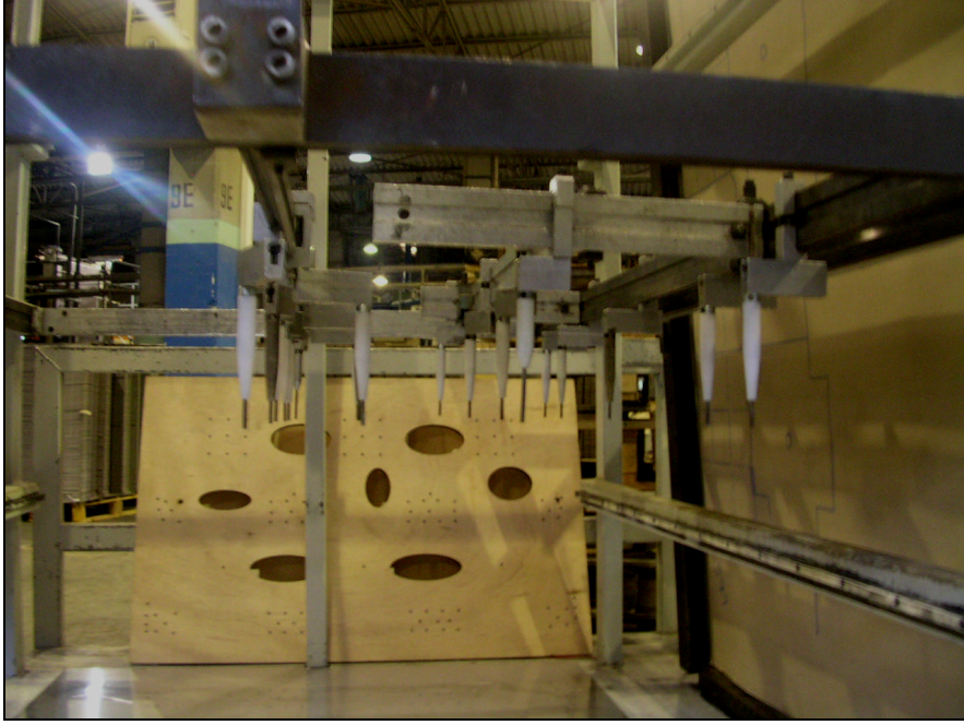
Şekil 1. 9.: Dişi ayıklama çerçevesi, üst düşürme pimleri ve takılması
