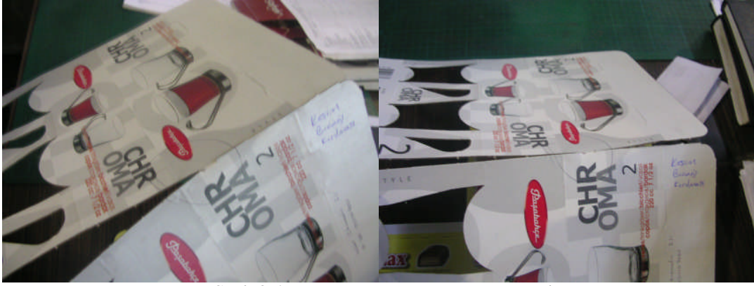
Şekil 3.6: Kesme bıçağının tam kesmemesi
