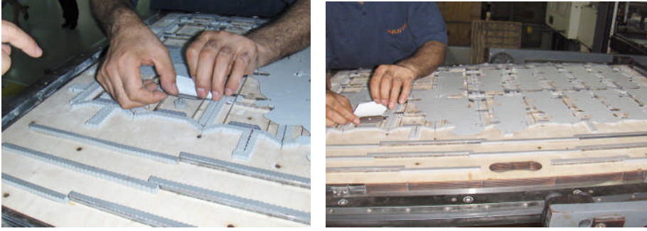
Şekil 1. 20.: Rilmanın kesim kalıbının üzerine takılması
