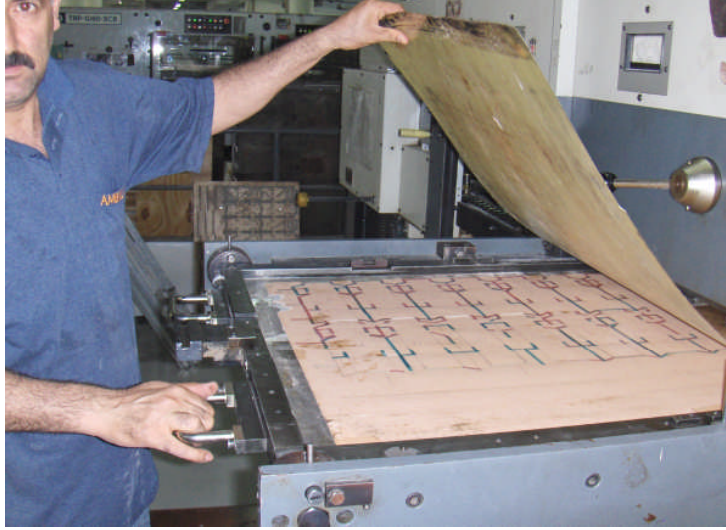
Şekil 2.4: Mizantren yapılan kesim kalıbı
