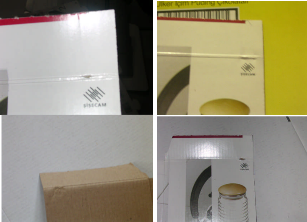
Şekil 3.7: Oluk genişliğinin karton kalınlığına göre ayarlanmamasından dolayı kutu pilyajında çatlama
