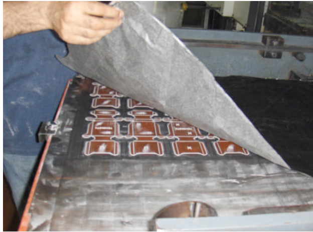
Şekil 2.3: Karşı kalıp rigma kartonu yapıştırma
