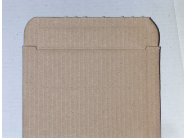
Şekil 3.5: Oluklu kartonun sert bıçak lastiği tarafından ezilmesi
