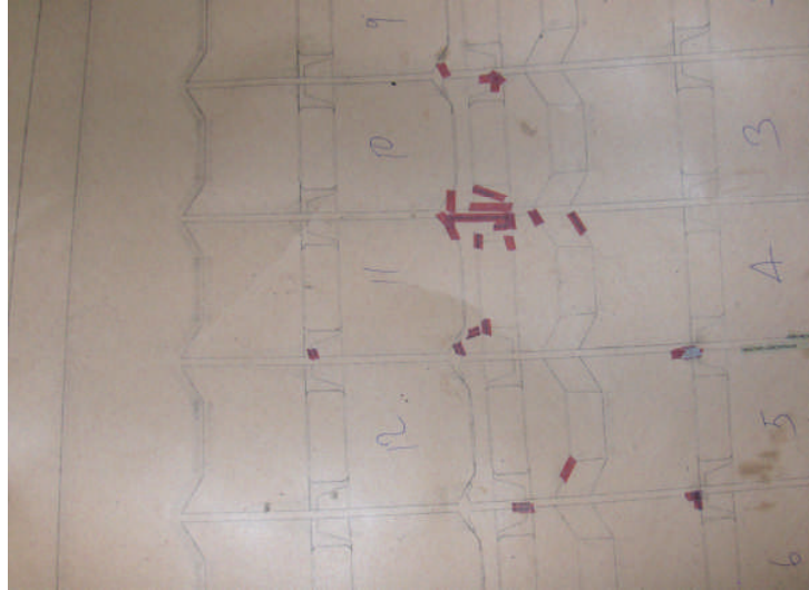
Şekil 2.5. Bıçak izi ve mizantren bandı yapıştırma
