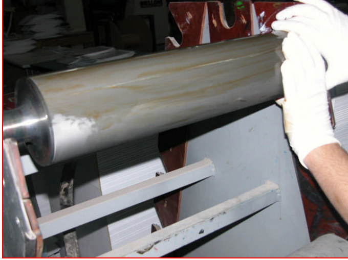
Resim 3.2: Aniloks hücrelerin temizlenmesi
