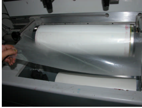
Resim 1.2: Kalıp altı yapıştırıcıların sökülmesi.
