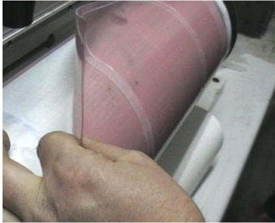
Resim 1.1: Baskı kalıplarının sleeve'lerden sökülmesi
