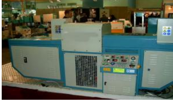
Resim 1.8 : Hidrozon ve konveyör kaynak makinesi
