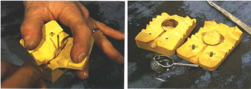
Resim 5.7: Kesim işleminin tamamlanarak modelin çıkarılması
