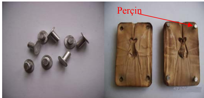
Resim 1.5: Merkezlemede kullanılan perçin ve kalıplanmış hali
