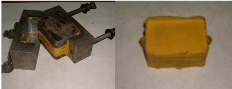
Resim 4.4:Pişirme işlemi sonrası kauçuk kalıbın pişirme derecesinden alınması
