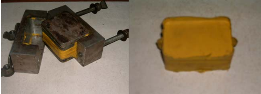
Resim 5.1:Kauçuk kalıbın pişirme derecesinden alınması
