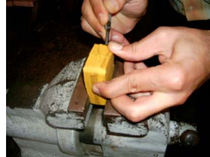
Resim 5.6: Kalıbın açılarak kesimin yapılması
