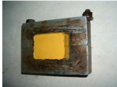
Resim 3.3: Pişirme derecesi içerisinde kauçuğun konumu
