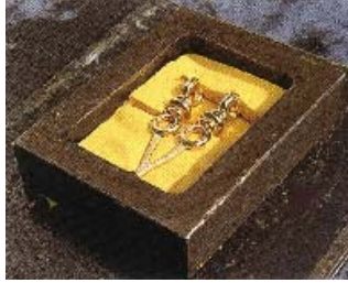
Resim 4.1: Modelin kalıba yerleştirilmesi
