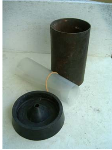
Resim 7.3: Derecenin plastik bant ve lastik althıkla görünümü
