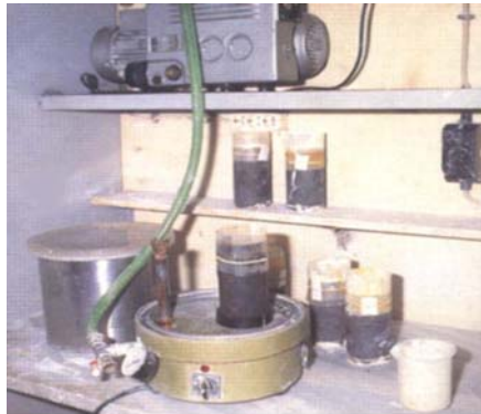
Resim 7.2: Derecenin vakum makinesine yerleştirilmesi
