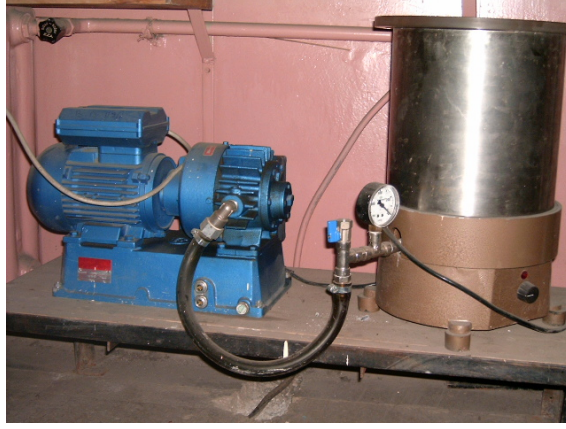
Şekil 7.2: Vakumlama makinesi ve kısımları
