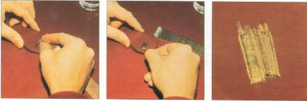
Resim 1.2: Mihenk taşı üzerine test çizgilerinin oluşturulması
