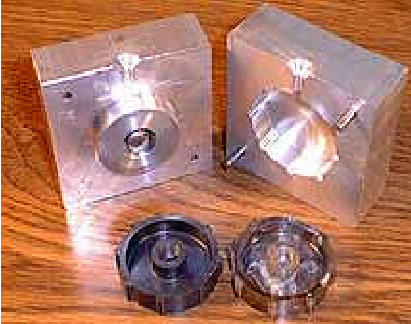
Şekil 3.3. Tipik bir el enjeksiyonu kalıbı
