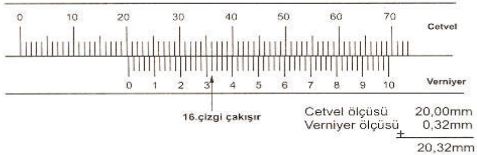
Şekil 2.20. 1/50 Verniyerli Bir Kumpasta Örnek Bir Ölçüm (20.32 mm)
