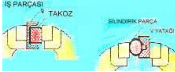
Şekil 1.5. İş Parçasının Mengeneye Bağlanması
