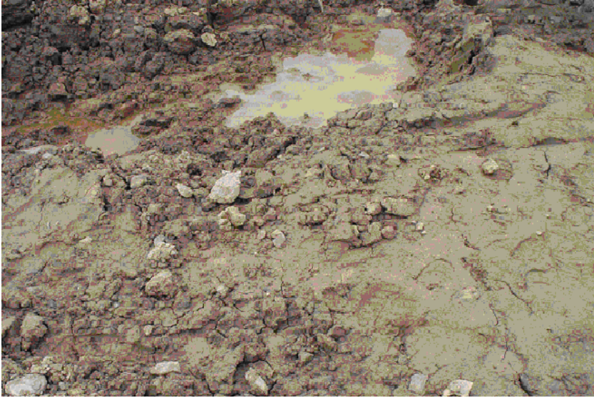
Resim-7 : Bataklık zemin ( Islah Çalışması , Fazla Kazı ve Dolgu Gerektirir).
