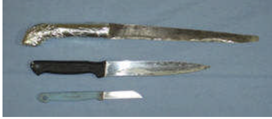
Resim 1.13: Yalıtım malzemesini kesme bacakları
