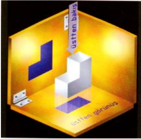
Şekil 1 6: Cismin yatay epür düzlemi üzerine taşınması
