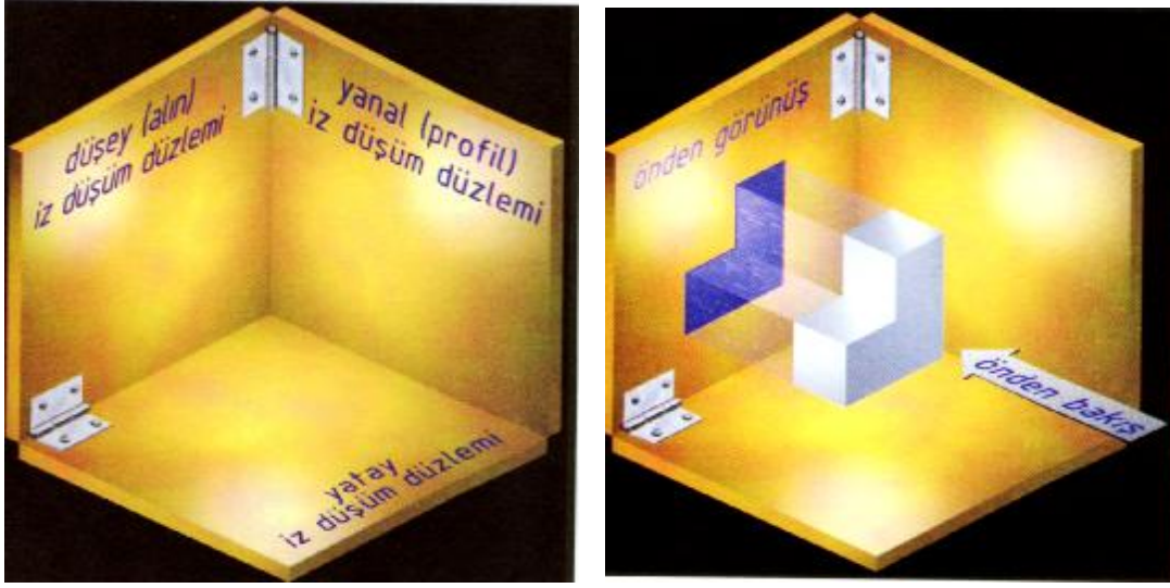
Şekil 1.5: Cismin alın düzlem üzerine yerleştirilmesi
