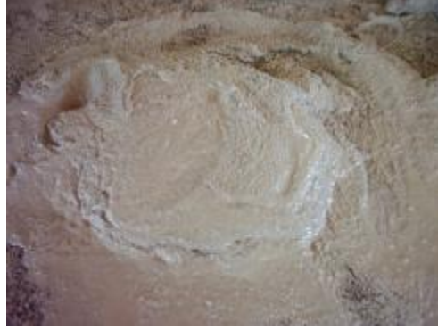
Resim 2.4: Akıcı kıvamda hazırlanmış çimento harcı
