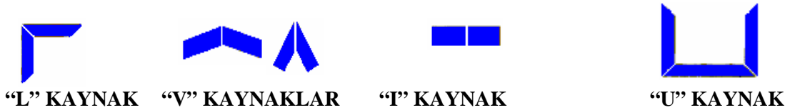
Şekil 28 – Değişik Açılarda Yapılmış Kaynak Çeşitleri
