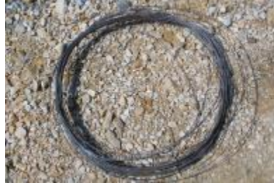
Resim 5.2: Demir bağlama teli
