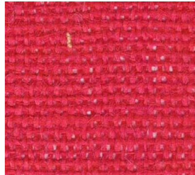
Bezayağı Bağlantılı Dokuma Kumaş
