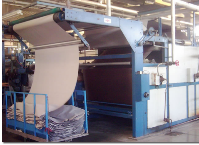
Gerdirme işleminin yapıldığı makine
