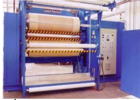
Kalandırlama İşleminin Yapıldığı MakineGörmüş Kumaş
