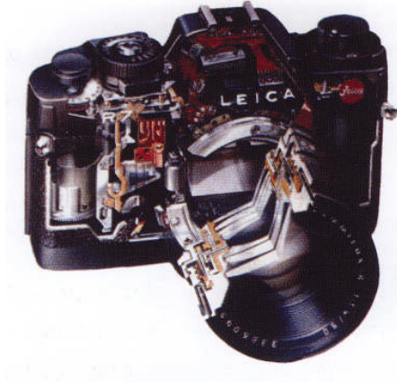
Resim 3.1. Fotoğraf makinesinin kesiti
