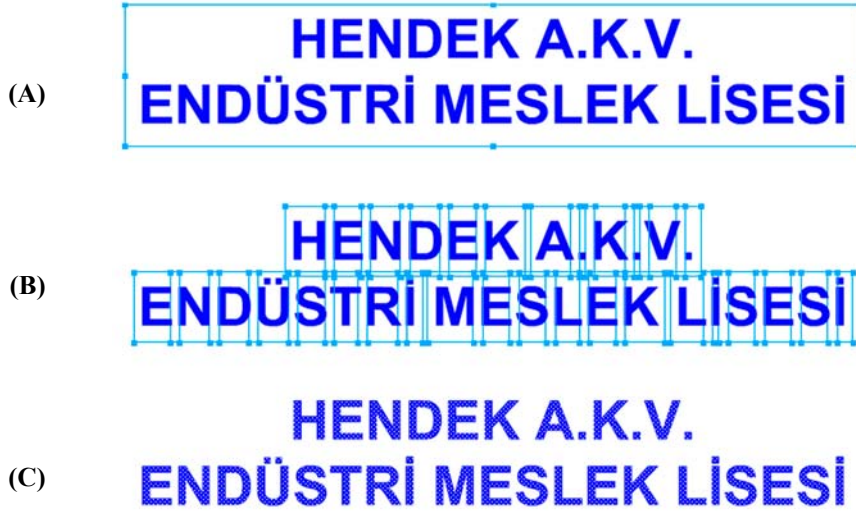
Şekil 4.4: (A) Bütün metin grubu. (B) Break Apart komutu uygulanmış metin grubu. Artık her bir harf bağımsız. (C) Break Apart komutu ikinci kez uygulanıyor. Artık yazı metin özelliğini kaybediyor.
