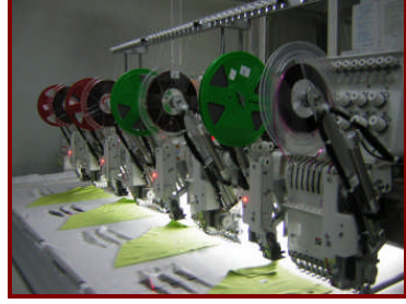
Resim: Kumaşın yerleştirilmesi
