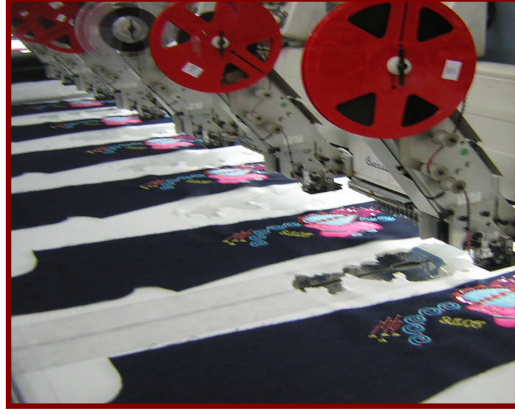
Resim 7.4.9:Küçük kumaşın makineye gerilmesi
