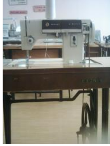
Resim 1.16: Zikzak Dikiş Makinesi Dikiş Makinesi
