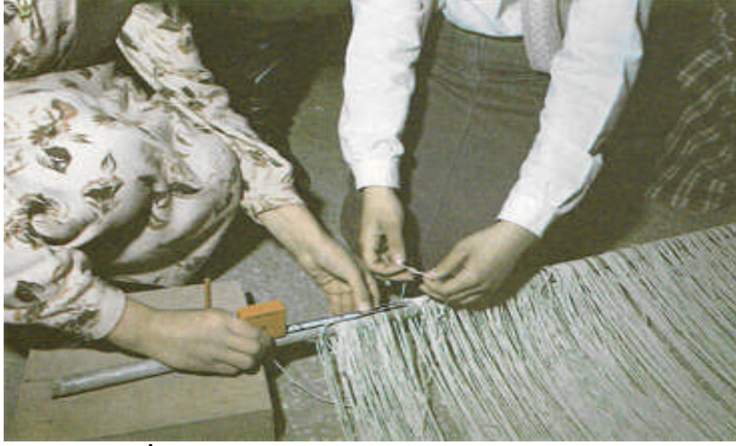
Resim 2.4: İşaretlenen tellerin 10 cm arayla aralarının bağlanması
