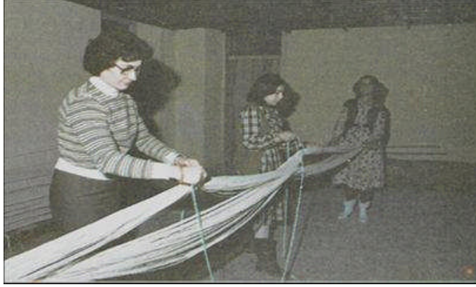
Resim 2.2: Çözü çaprazının arasına urganın takılması
