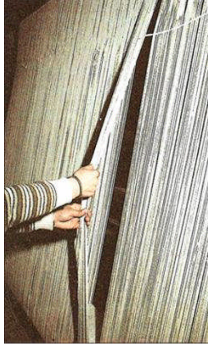
Resim 2.7: Çözünün üst merdaneye sarılarak bol tel kalmaması için tutam halinde çekilmesi
