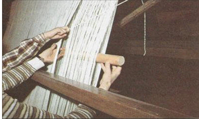
Resim 2.8: Urganın ve tellerin arasından gücü kalıbının geçirilmesi
