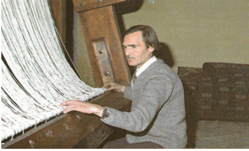
Resim 2.6: Alt çubuk demirinin alt merdaneye yerleştirilmesi
