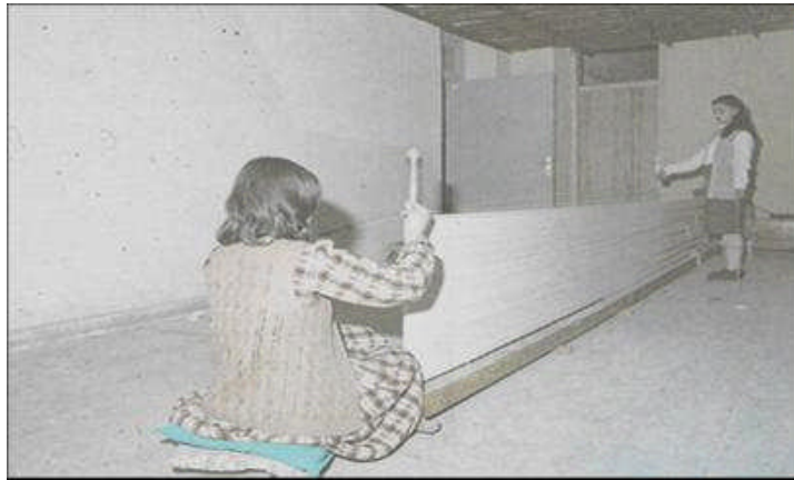
Resim 2.1: Çözgü aletinde çözgünün yapılışı
