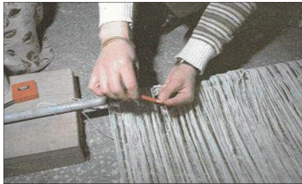
Resim 2.3: Çözüünün her 10 cm. de olması gereken tel sayısının işaretlenmesi
