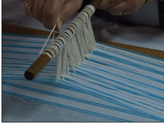
Resim 2.9: El gücüsü yapımı
