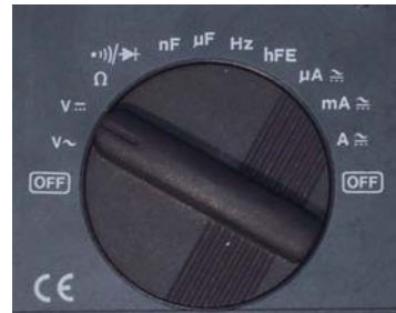
b-Tekli kademeye sahip avometre
