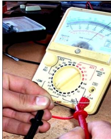
Şekil 1.8: Avometre ile direnç ölçümü
