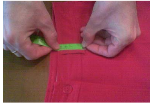
Kemer köprüleri ölçü kontrolü
