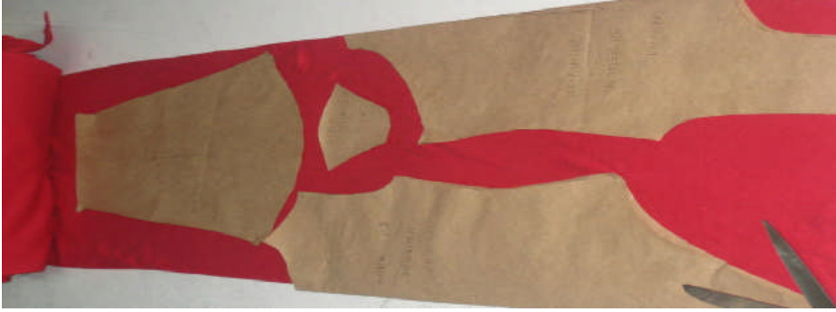
Resim 1.2: Kalıpların kumaşa yerleştirilmesi
