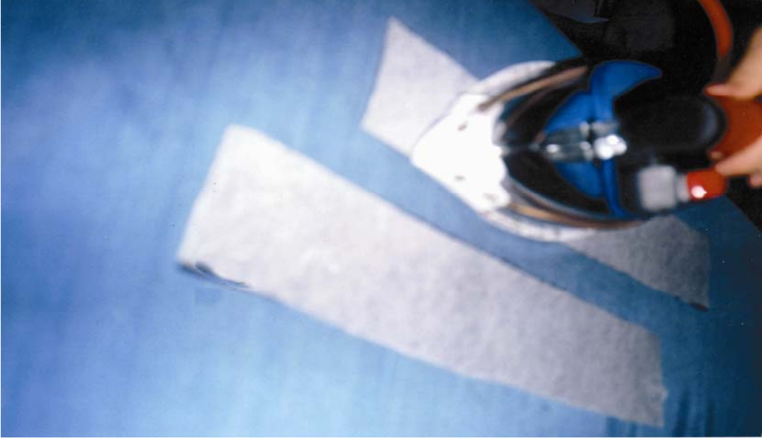
Yaka Teta Yapıştırma
