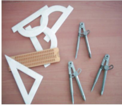
Resim1.40:Geometrik şekillerin çizilebilmesi için özel olarak yapılmış, kabartma rakamları olan pergel,cetvel,iletkive gönye.
