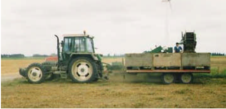
Fotoğraf 1.8: Sümbül soğanı dikim makinesi
