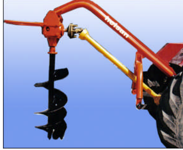
Fotoğraf 1.38: Fide yalaklarını kazmak için kullanılan burgu makinesi
