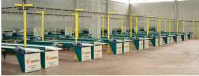
Fotoğraf 3.8: Narenciye işleme, mumlama, sınıflama ve paketlenme hattı
