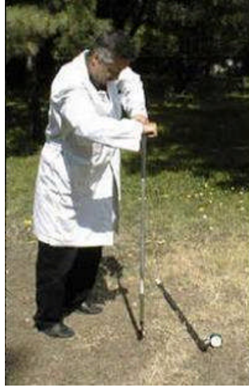
Fotoğraf 2.3: Tansiyometrenin toprağa saplanması
