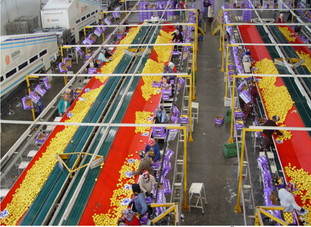
Fotoğraf 3.9: Bir fabrikada limonların pazara hazırlanması (Ürün işleme hattı )
