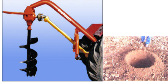
Fotoğraf 1.27: Fide yalıklarının kazmak için kullanılan burgu mak. ve dikim çukuru
