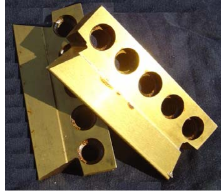
Resim 2.9: Planyalayarak yuvarlanma metoduna göre konik dişli açan tezgâhlarda kullanılan kesici bıçaklar
