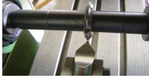
Resim1.16: Dişli taslağı ve modül freze çakısının sabit punta ile eksen ayarının yapılması
