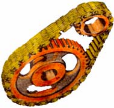
Resim 1.4: Dişli zincir dişli çarkı ve zinciri ile kullanılması
