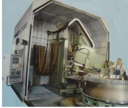
Resim 2.6: CNC azdırma freze tezgahında helis ve düz dişlinin açılması
