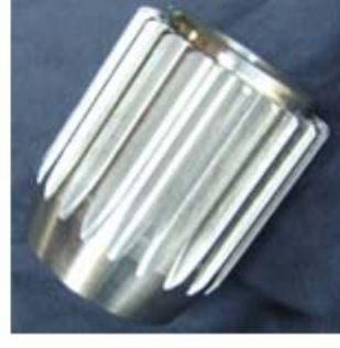
Resim 2.7: Azdırma freze tezgahında açılmış sonsuz vida karşılık dişlisi, helis ve düz dişliler
