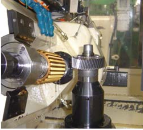
Resim 2.6: CNC azdırma freze tezgahında helis ve düz dişlinin açılması
