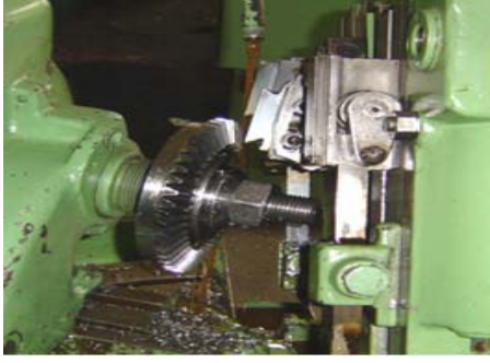
Resim 2.10: Planyalayarak yuvarlanma metoduna göre konik dişli açan tezgâh Resim 2.11: Planyalayarak yuvarlanma metoduyla açılmış konik dişli
