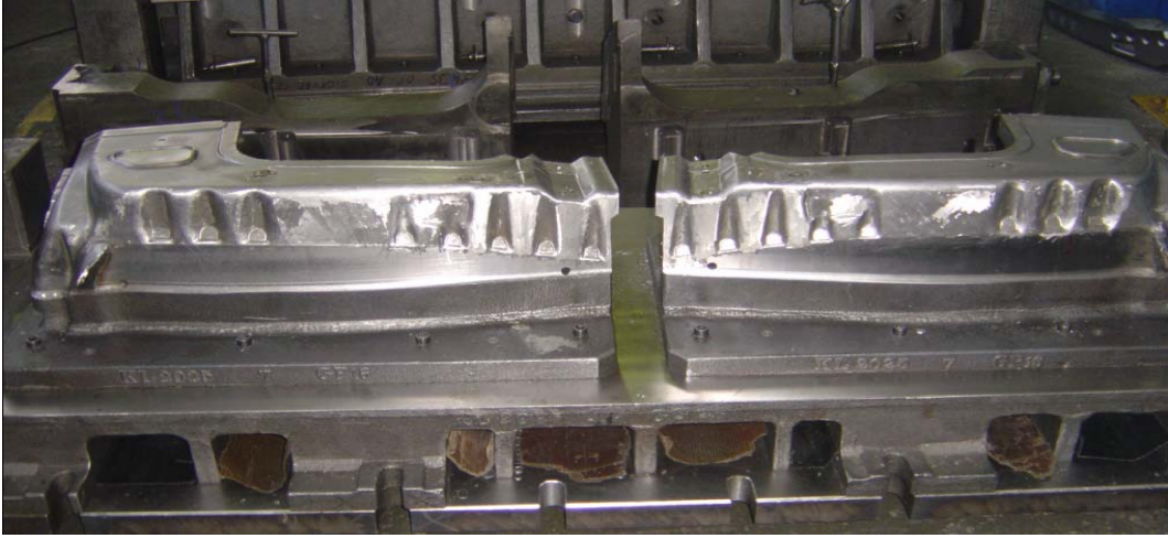
Resim 2.18: Kopya freze tezgâhında işlenmiş kalıp parçaları
