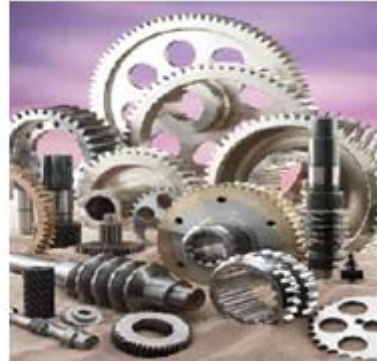
Resim 2.1: Dişli açma tezgâhlarında açılan muhtelif dişli çarklar
