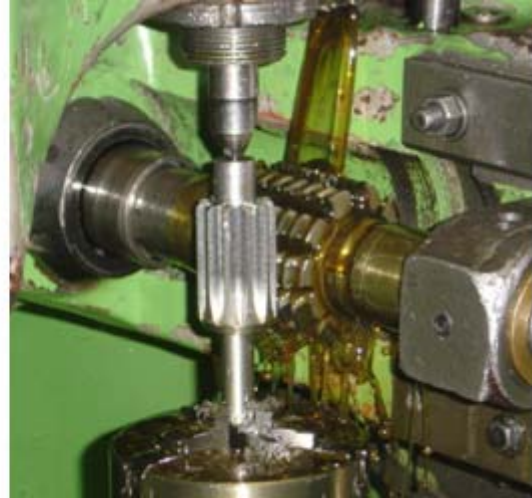
Resim 2.5: Azdırma freze tezgahında helis ve düz dişlinin açılması
