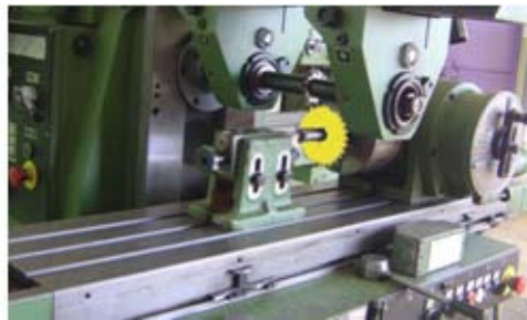
Resim 1.18: Divizör makası ayarının yapılup zincir dişli çarkın açılarak tamamlanması
