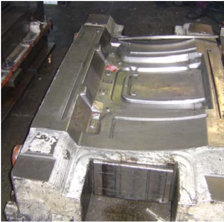
Resim 2.24: Planya tipi freze tezgâhlarında işlenmiş büyük kalıp parçaları
