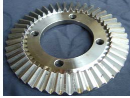
Resim 2.10: Planyalayarak yuvarlanma metoduna göre konik dişli açan tezgâh Resim 2.11: Planyalayarak yuvarlanma metoduyla açılmış konik dişli
