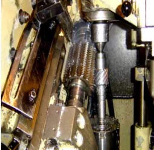
Resim 2.5: Azdırma freze tezgahında helis ve düz dişlinin açılması
