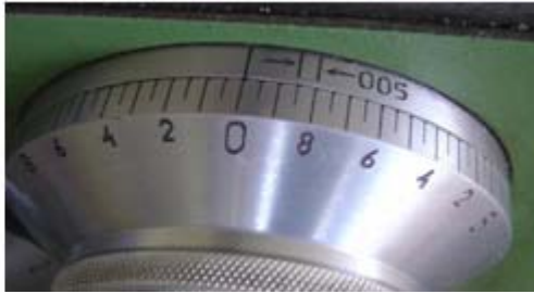
Resim1.17: Modül çakısının kağıt kullanarak taslağa teğet hala getirilmesi ve mikrometrik bileziğin sıfırlanması
