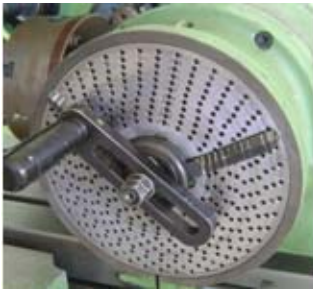
Resim 1.18: Divizör makası ayarının yapılup zincir dişli çarkın açılarak tamamlanması
