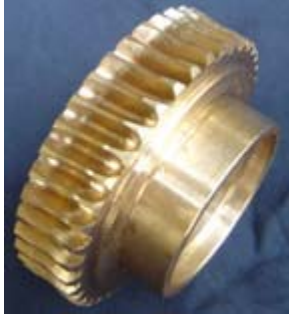
Resim 2.7: Azdırma freze tezgahında açılmış sonsuz vida karşılık dişlisi, helis ve düz dişliler
