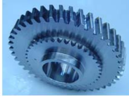
Resim 2.7: Azdırma freze tezgahında açılmış sonsuz vida karşılık dişlisi, helis ve düz dişliler
