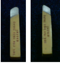
Resim 1.4: Sağ ve Sol Yan Kalem
