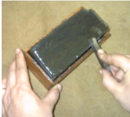
Resim 1. 10: Yağ Taşı İle Kılağı Alma
