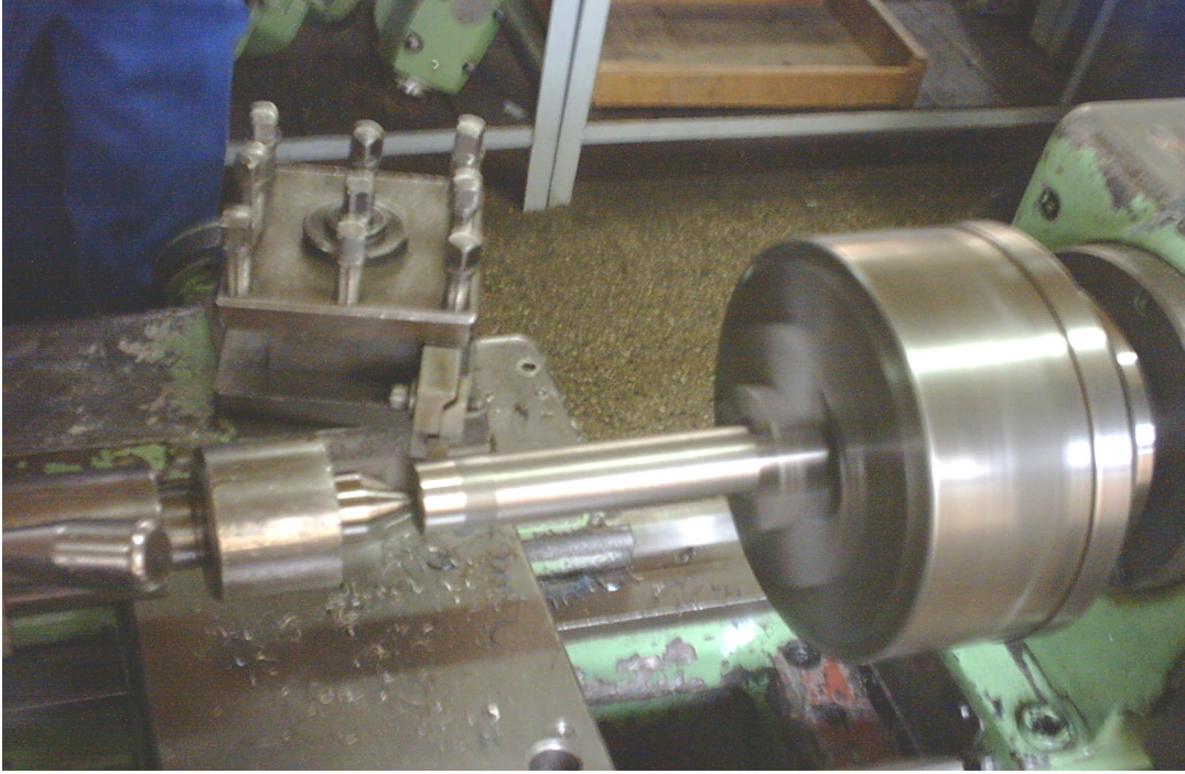
Resim 7.3:Torna Tezgahında Silindirik Dış Yüzey Tornalama
