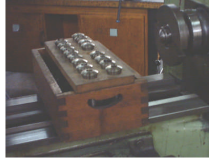
Resim 3.7: Değişik Çaplardaki Pensler ve Tornaya Bağlanması
