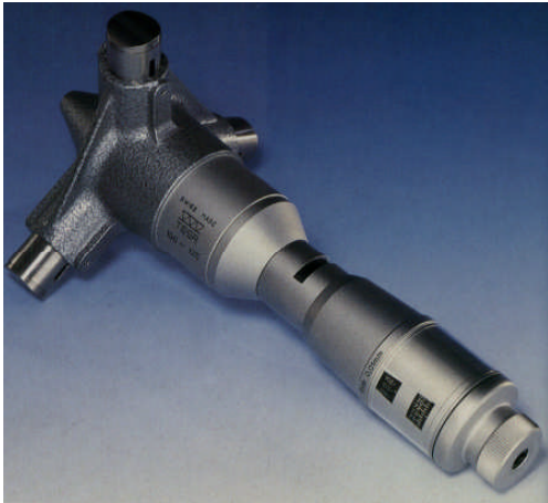
Resim 4.10: İç Ölçü Mikrometresi ve Kullanılması
