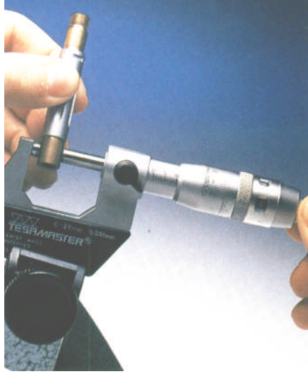
Resim 4.9: Mikrometre İle Dış Ölçüm Yapılması
