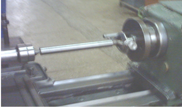
Resim 7.2: İş Parçasını Firdöndü Aynası İle İki Punta Arasında Bağlama
