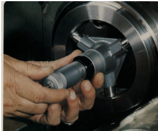
Resim 4.10: İç Ölçü Mikrometresi ve Kullanılması
