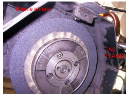
Resim1.17: Taşın Hidrolik Sistemle Otomatik Bilenmesi
