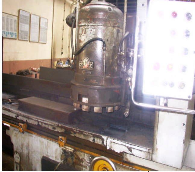
Resim 1.18 Düşey Milli Taşlama Tezgahında Taşın Çapının İş Kenarından Tamamen Çıkması
