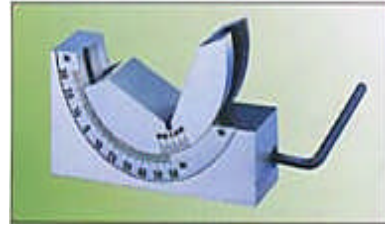
Resim 1.7: Açılı V Yatağı ve Açı Ayarının Yapılması
