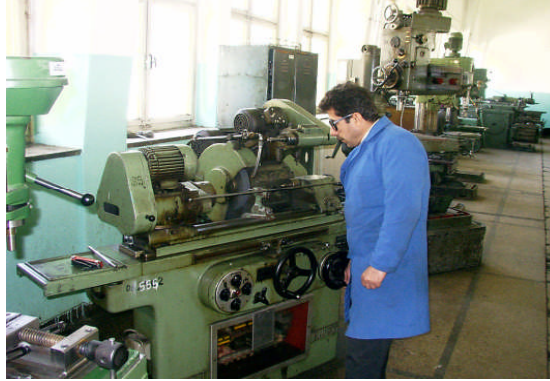
Resim 2.8: Silindirik Taşın Bileme Aparatı İle Bilenmesi
