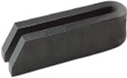
Resim 1.11: Kanallı Pabuç ve Kanallı Pabuçla İşin Bağlanması
