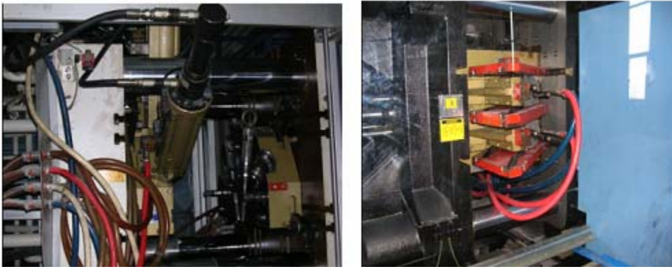
Şekil 1.19: Hidrolik sistemle çalışan maçalı kalıplar
