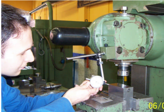
Resim 1. 1:Mengenenin Tablaya Komparatörle Paralel Hale Getirilmesi
