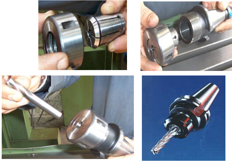
Resim 1. 7 : Pens Tertibatının Montajı Ve Parmak Frezenin Takılışı
