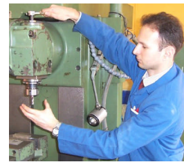
Resim 1.6: Pens tertibatının Freze Dik Başlığına Çektirilmesi
