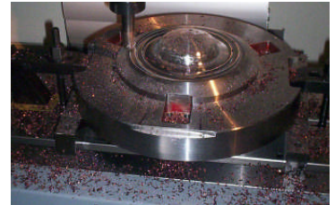
RESİM 2.5 : İş Parçasını Civata ve Pabuçlarla Bağlama
