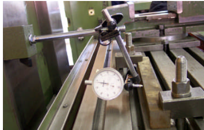
RESİM 2.4 : Komparatörle İş Parçasının Gövdeye Paralel Bağlama
