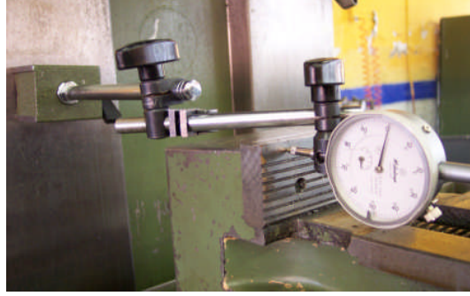
RESİM 2.1 : Mengene Ağzlarının Komparatörle Gövdeye Paralellik Ve Diklik Kontrolü
