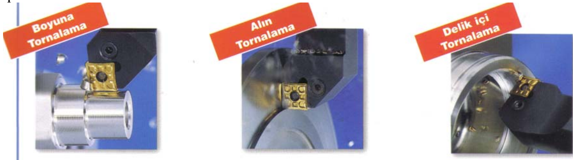
Şekil 2.2: Tornalama işlemi tipleri
