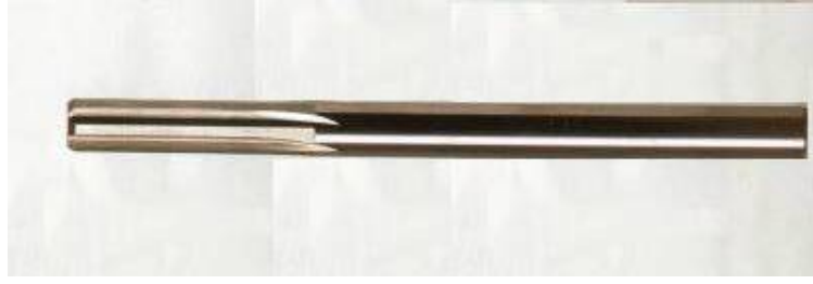
Şekil 2.5: Raybalama işleminde kullanılan rayba
