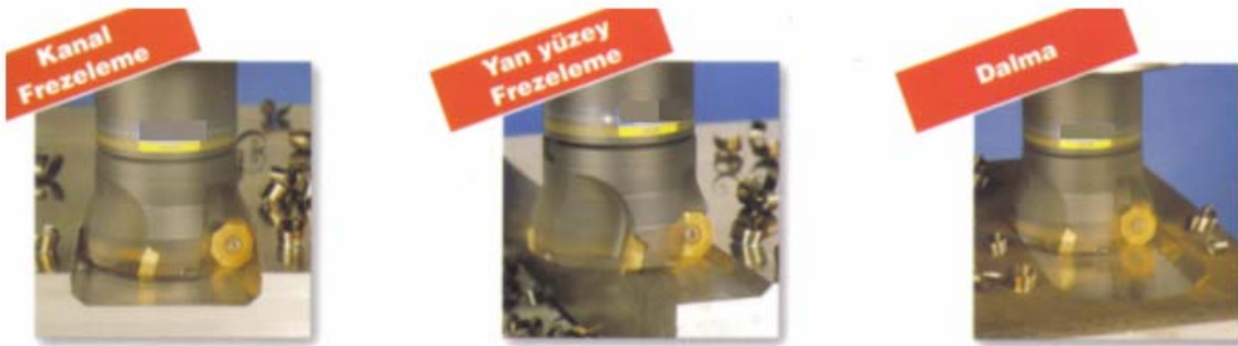
Şekil 2.3: Frezeleme işleminin tipleri
