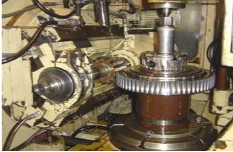
Resim 2.1: Karşılık dişlisinin azdırma freze çakısıyla açılması
