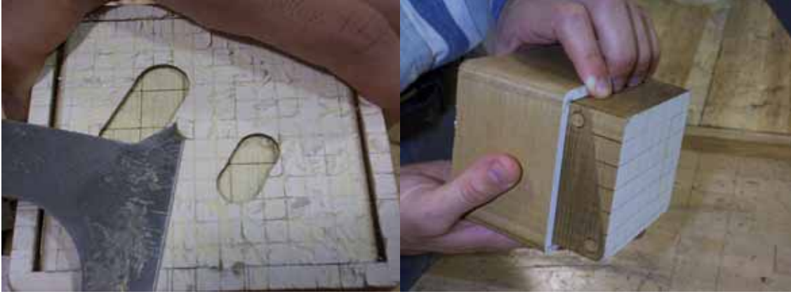
Resim 2.22: Model harici destek malzemelerin dikkatlice kazanması
