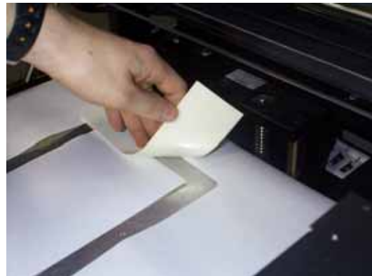
Resim 2.15: Kâğıt üzerinden çerçeve kesilmesi ve iki tarafı köpüklü kağıdın kesilen kısma yapıştırılması
