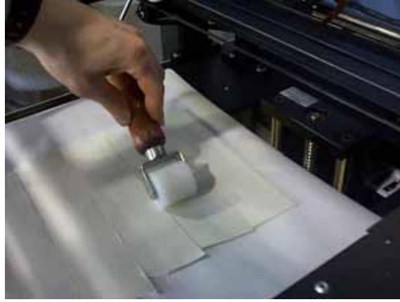
Resim 2.16: Köpük kâğıtlar kullanıp modelleme alanının hazırlanması
