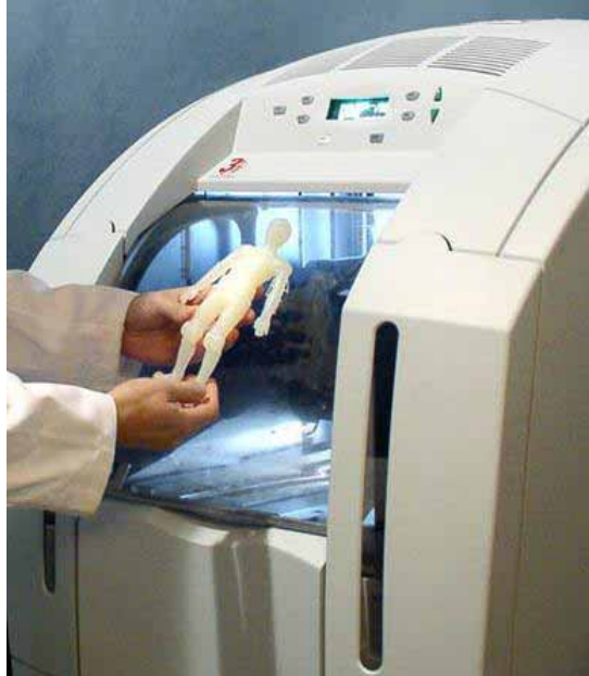
Resim 1.1: Tipik bir damlacık püskürtme cihazı
