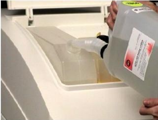
Resim 2.7. Suport yapıştırıcısının doldurulması
