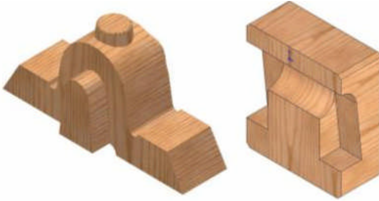
Resim 2.2: Ana modelleme ve maça sandığı
