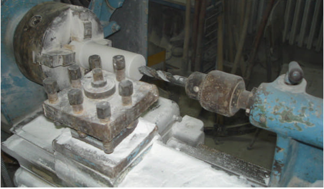
Resim 1.5: Matkabin mandrenle tornaya bağlanması
