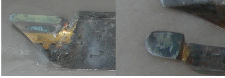
Resim 1.10: Kalemın bilenmesi ve profili
