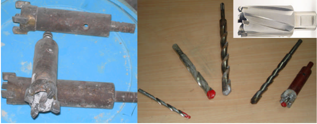
Resim 1.3: Büyük çaplı delikleri delmede kullanılan matkaplar
