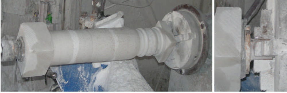
Resim 2.7: İş parçasının aparatla tezgaha bağlanması
