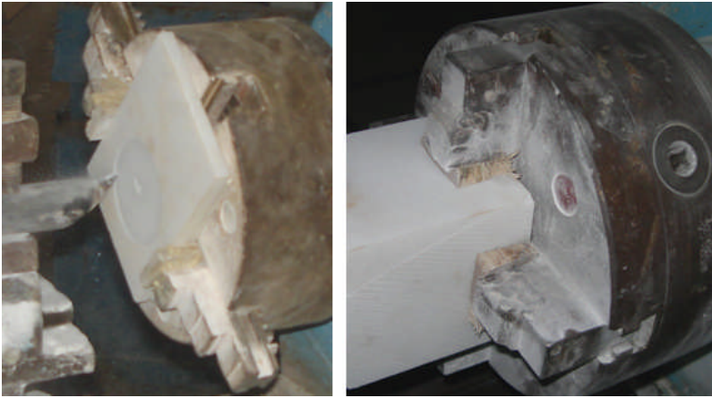
Resim 2.6: İş parçasının aynaya doğrudan baęlanması
