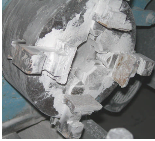
Resim 2.2: Ayaklarına takoz yapıştırılmış ayna
