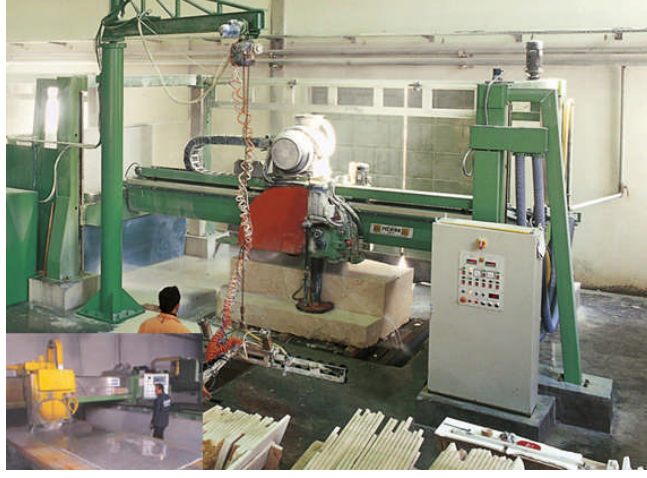
Resim 2.5: Bilgisayar kontrollü ST ile blok kesimi
