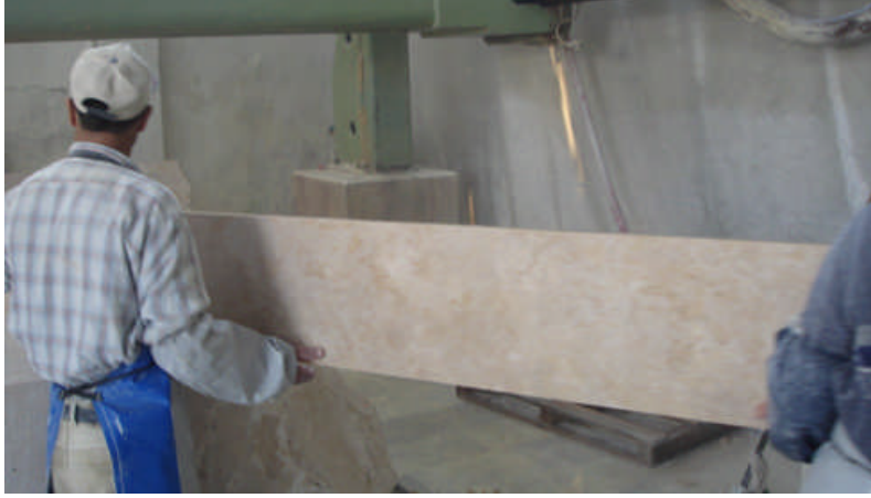
Resim 2.14: Blok üzerinden kesilen plakanın alınışı
