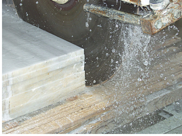
Resim 1.9: Elmas soketli dairesel testere ile sulu kesim
