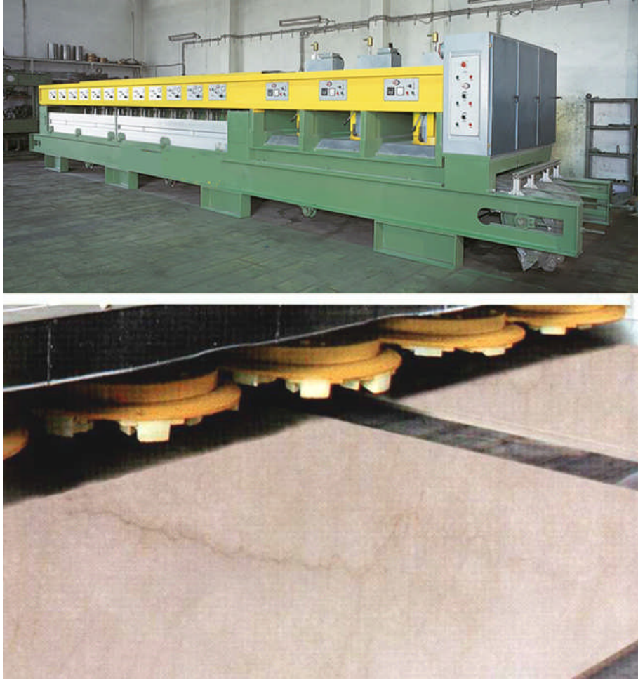
Resim 1.4: Cila makinesi, bant üzerinde plaka ilerlemesi ve aşındırıcı takılmış başlıklar
