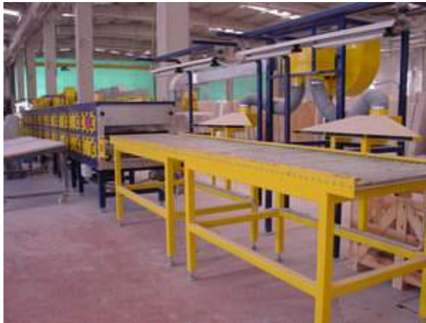
Resim 2.4: Strip çatlak tamir/dolgu hattı
