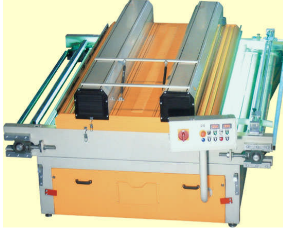
Resim 2.14: U.V. sistem reçine kurutma (3)
