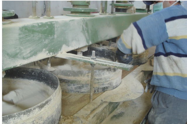
Resim 2.10: Çimento dolgu makinesinde uygulama
