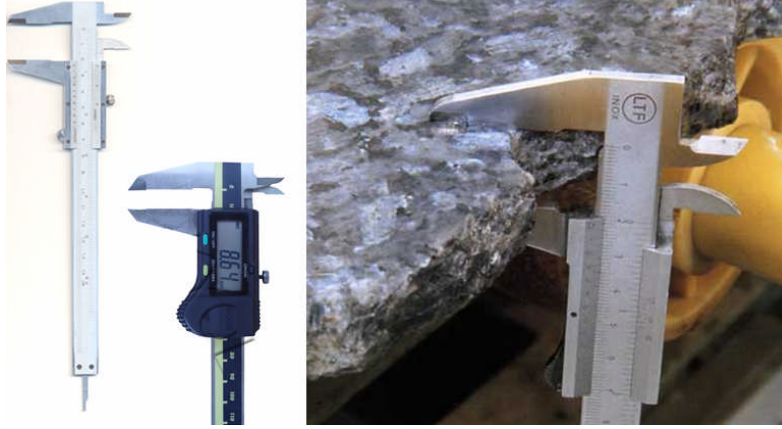
Resim 1.13: Verniyerli kumpas, dijital kumpas ve plaka kalınlığının ölçülmesi
