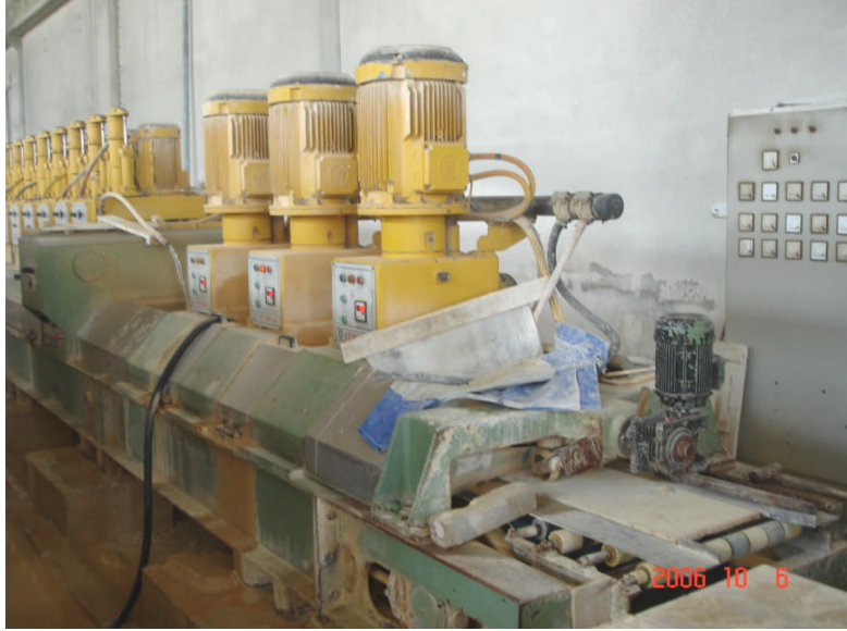
Resim 1.1: 3+12 kafalı kalibreli cila makinesi
