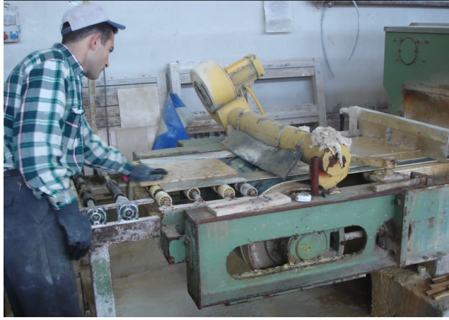
Resim 2.8: Fayansların dolgu hattı bandına yerleştirilişi
