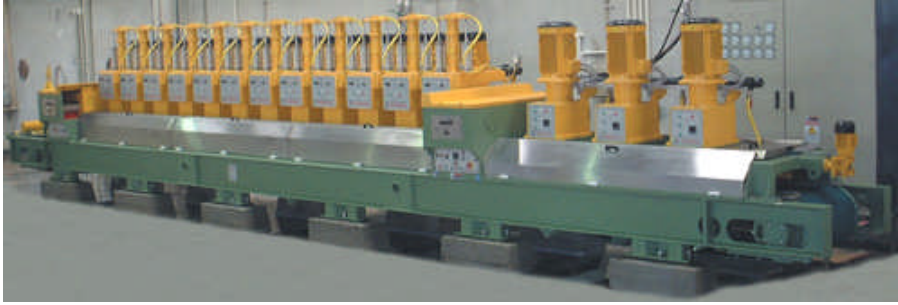
Resim 1.2: 3+12 kafalı kalibreli cila makinesi
