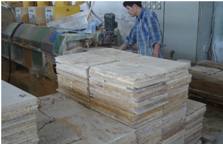
Resim 1.11: Plakaların bant üzerine yerleştirilmesi
