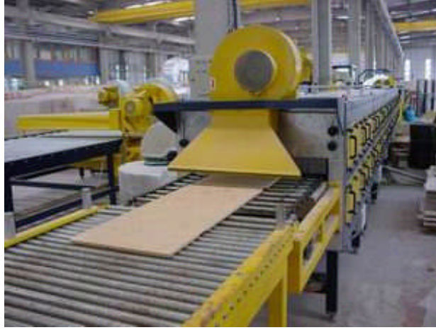
Resim 2.3: Çatlak tamir hattı
