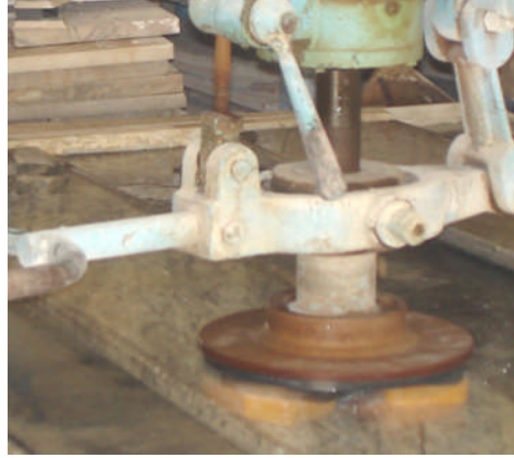
Resim 1.14 Makinenin su sistemi ve mermere temiz su verme
