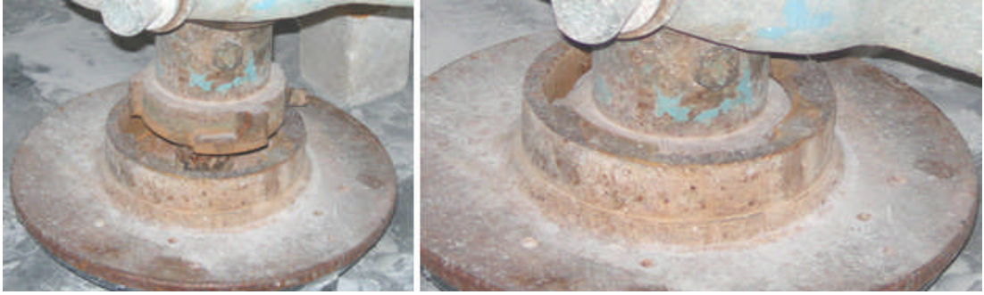
Resim 1.6: Pleytin tezgâha bağlanması
