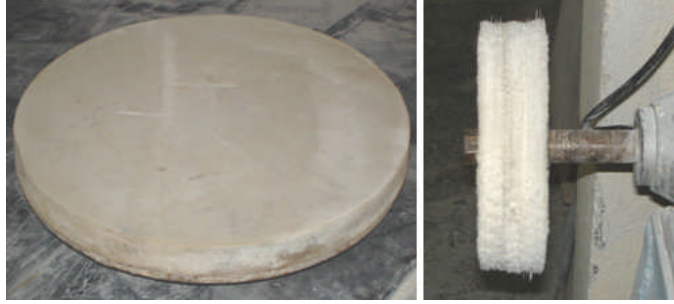
Resim 1.11: Pleyte yapıştırılmış ve mile takılmış keçe
