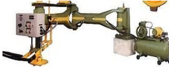
Resim 1.16: Perdah makinesinin pnömatik ünitesi
