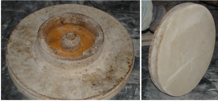
Resim 2.2: Pleyte yapıştırılmış keçe
