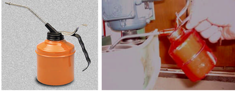
Resim 5.1: Yağdanlık ve yağdanlık ile yağlama
