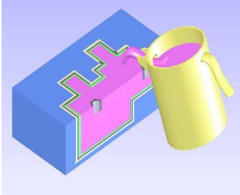
Resim 1.9: Kalıba dolgu reçinesi ve karışım oranlarının dökülmesi
